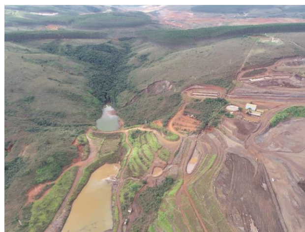
Região acidentada em 2014, objeto de reforço com enrocamento em itabirito e geometrização dos taludes
